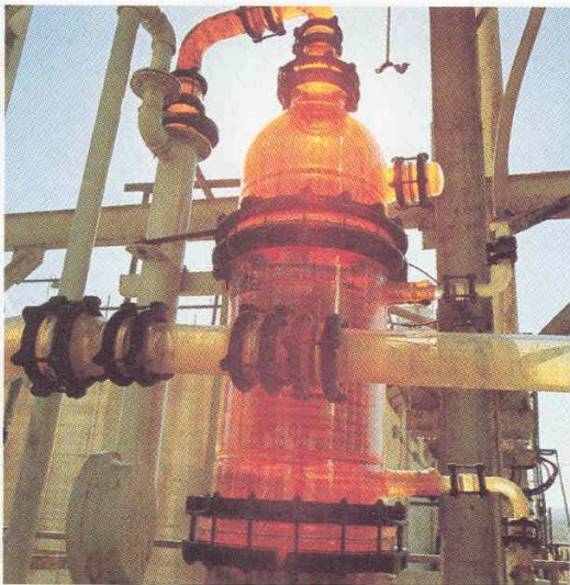
រូប ១៧ ការផលិតបែបឧស្សាហកម្មនៃទឹក ប្រូមដោយការធ្វើអុកស៊ីតកម្មសូលុយស្យុង ទឹកដែលមានផ្ទុកអ៊ីយ៉ុង \text{Br}^- ជាមួយឧស្ម័ន ក្លរ ។
